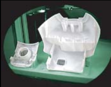
熱溶融積層造形RP : Stratasys FDM 8000 最大モデル幅 : X10 × Y560 × Z10mm
