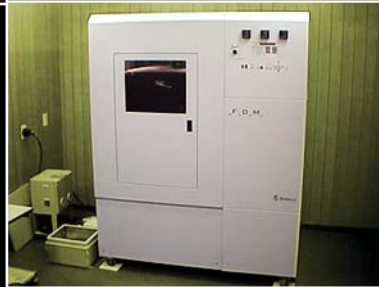
熱溶融積層造形RP : Stratasys FDM 8000 最大モデル幅 : X10 × Y560 × Z10mm
