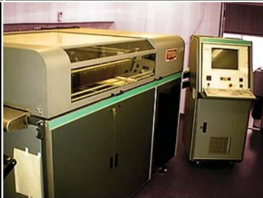
熱溶融積層造形RP : Stratasys FDM 8000 最大モデル幅 : X10 × Y560 × Z10mm
