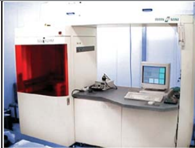
光造形RP : SOLIFORM 500 最大モデル幅 : X500 × Y500 × Z500mm
